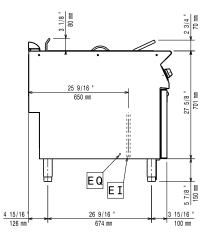
Electrical inlet (power) EQ **Equipotential screw**
